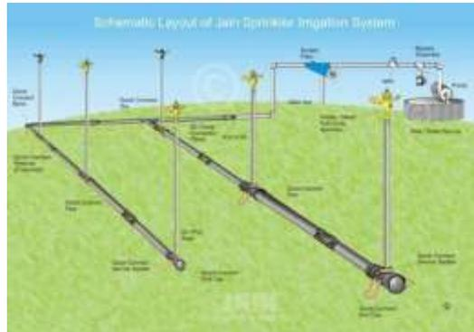
**Gambar 3. Sistem irigasi *sprinkler***
