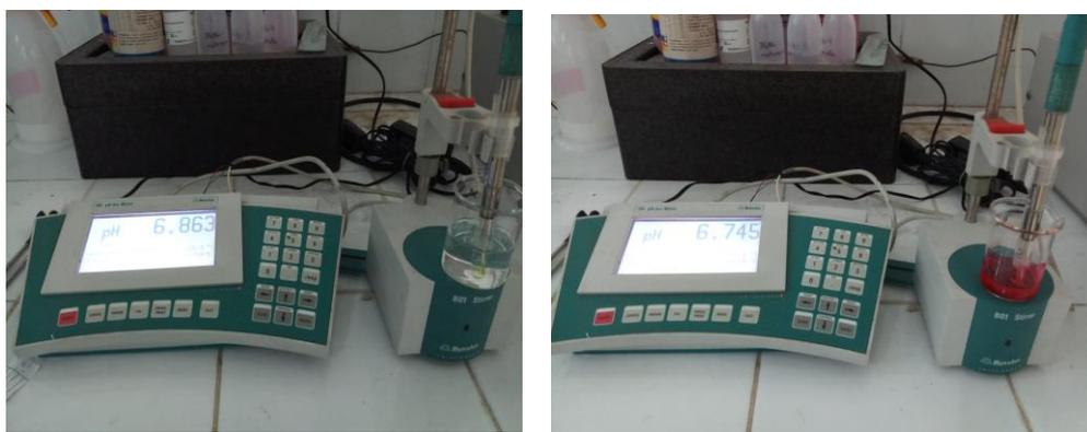
Gambar 4. Hasil uji pH *hand sanitizer* pelarut etanol (kiri) tanpa etanol (kanan)
