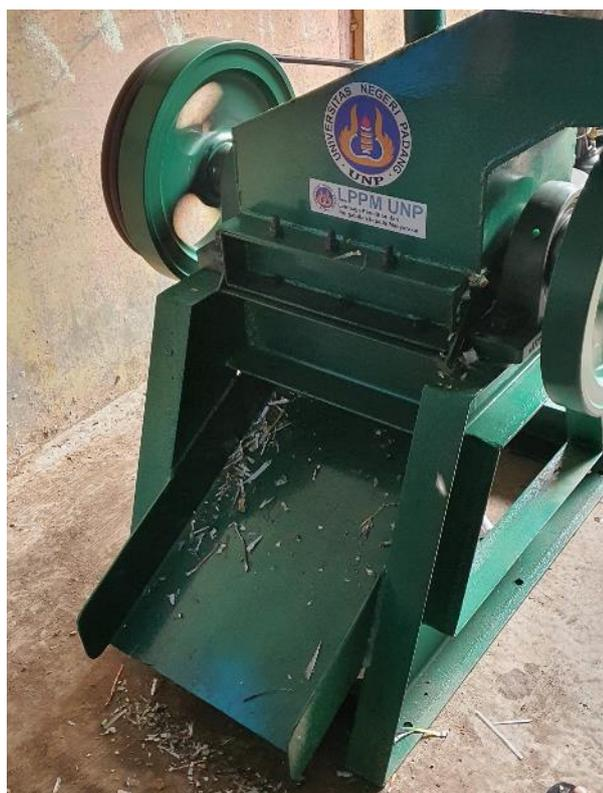
Gambar 3. Pengujian Mesin Pencacah Plastik
