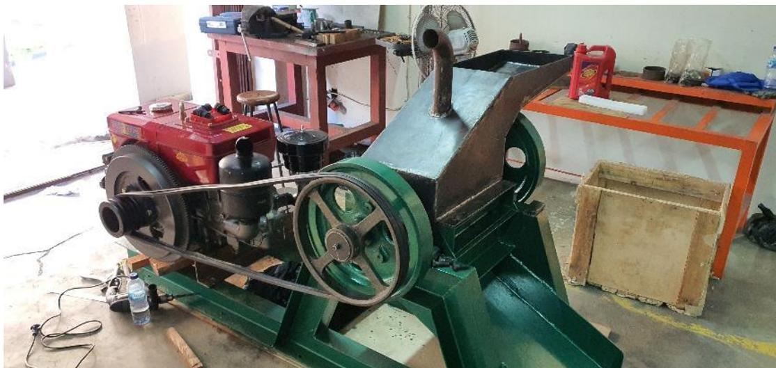
Gambar 2. Mesin Pencacah Plastik
