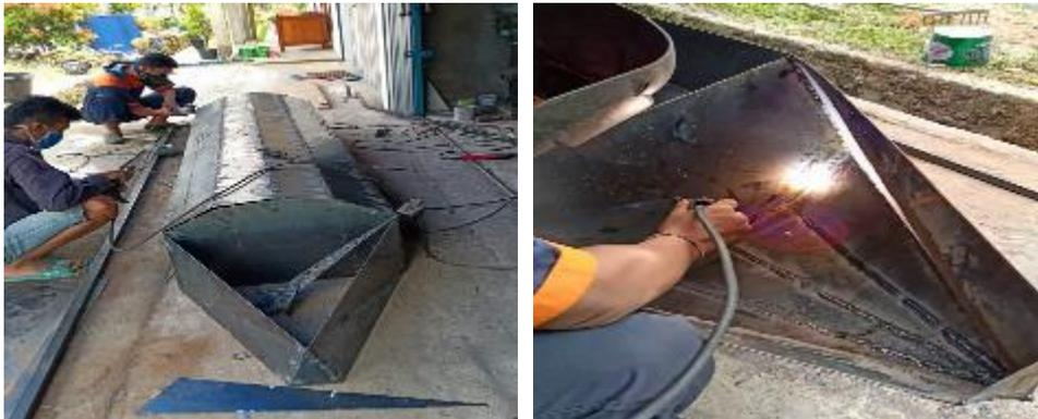
Gambar 5. Proses Pengelasan penuh pada penyambungan Pelat
